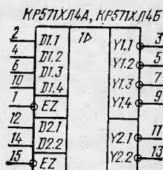
П.3.19. 2, 4, 6, 10, 12, 14 — входы; 1, 15 — входы управления третьим состоянием; 8 — общий; 16 — питание
